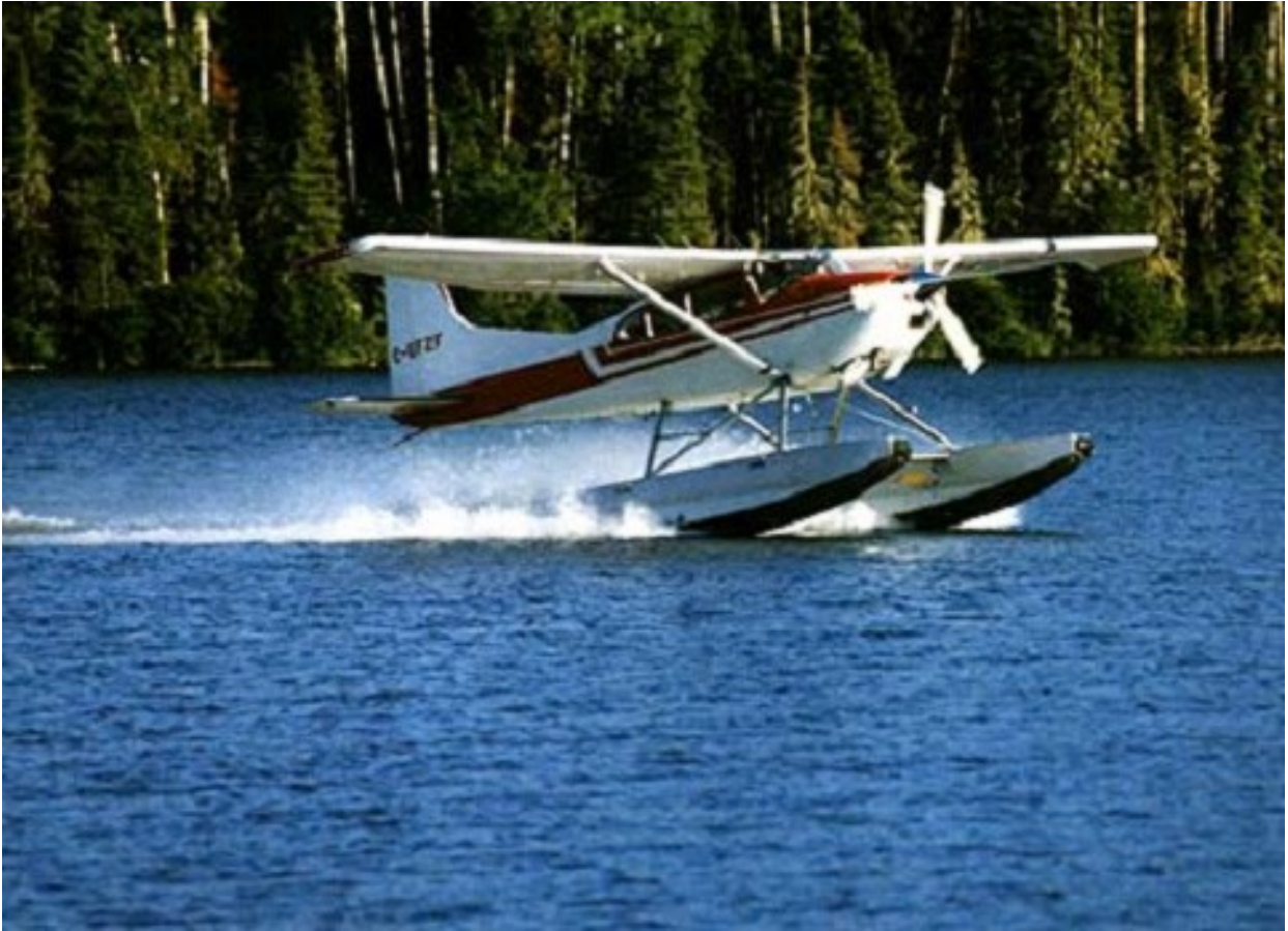
Cessna 185 Aurasasennossa, nousussa portaalle
